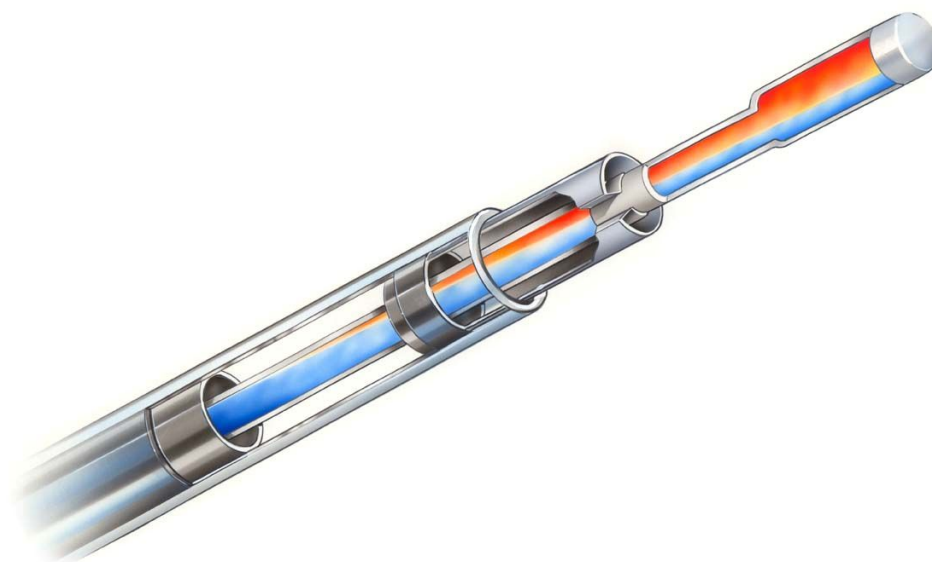
Vacuümbuis met heatpipe en aluminium vin.
